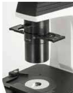
N.A. 0,3 Abbe Condenser with Phase Contrast Slide
